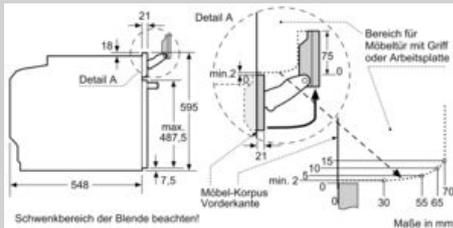
Wird das Gerät unter einem Kochfeld eingebaut, muss folgende Arbeitsplattenstärke (ggf. inkl. Unterkonstruktion) beachtet werden.
