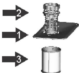
Filtrovací systém se skládá z hrubého filtru, plochého filtru (hlavní filtr) a mikrofiltru (jemný filtr).
